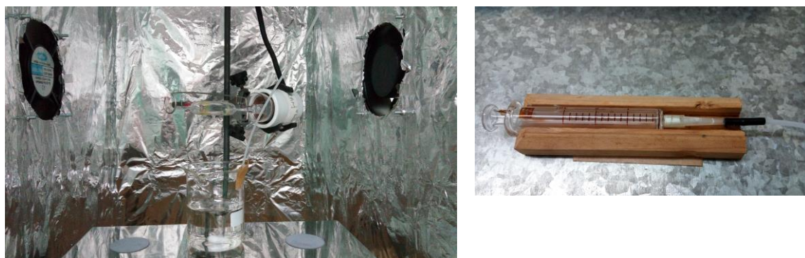
Figura 13 - À esquerda: sistema interno do foto-reator com a lâmpada a 10 cm na posição horizontal em relação ao béquer reacional, junto com a mangueira de retirada de alíquotas e as ventoinhas laterais. À direita: sistema de coleta de amostra, com seringa de 3,0 mL, conector e mangueira fina e longa (externa ao foto-reator).
