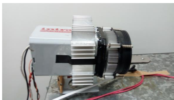
Figura 12 - Sistema de dissipação de calor do reator convencional (externo à caixa).
