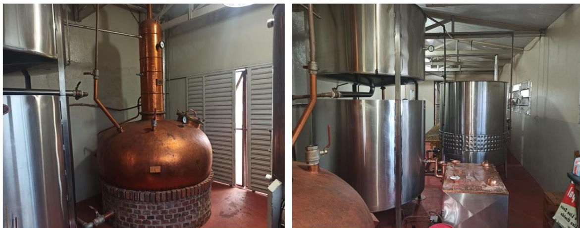
Imagem 20: Cebolão utilizado para destilação do caldo e serpentina utilizada para condensação do vapor.
