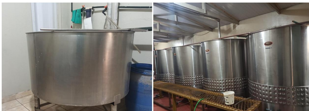
Imagem 19: Tambor inoxidável para preparação do caldo e dornas utilizadas para fermentação do caldo da cana. Fonte: Da Autora (2021).
