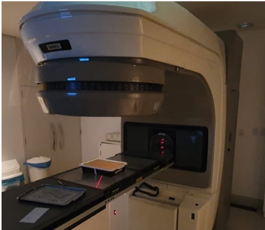
Figura 26 - Bloco de gelatina balística posicionado no acelerador linear de megavoltagem CLINAC 600 C/D.
