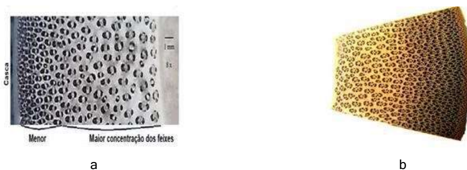
Figura 7. Concentração das fibras do colmo de bambu. (a) Representações laminar; (b) representação axial
