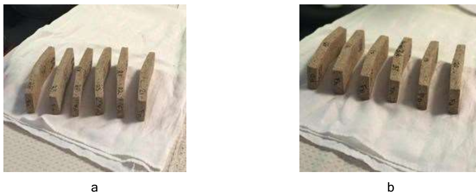
Figura 34. corpos de prova pós-ensaio de flexão: Bambusa vulgaris (a); Bambusa tuldooides (b).
