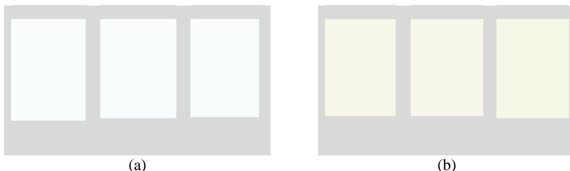
Figura 51 - Cor do substrato têxtil modelo CIElab, espectro de remissão: (a) sem realizar o acabamento e (b) com o acabamento de microcápsulas, sob iluminante D 65 , A10 e F 02 .
