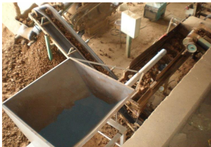
Figura 3.9 - Dosador mecânico para incorporação de lodo
