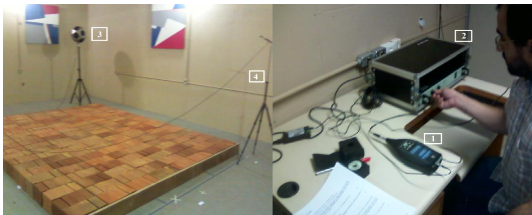
Figura 3.21 - Equipamentos utilizados no ensaio de absorção sonora
