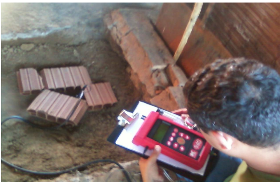
Figura 3.25 - Medição dos gases emitidos na queima dos blocos acústicos
