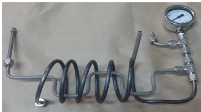
Figura 3-2. Imagem do evaporador do sistema reacional, na ausência das resistências e do isolamento.
