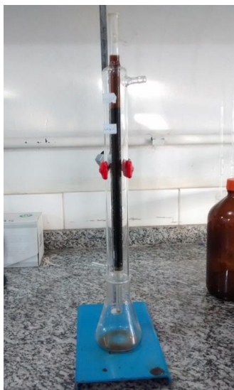
Figura IV. 6 - Coluna recheada com carvão de osso utilizada na purificação dos lipídios totais extraídos do lodo de esgoto seco.
