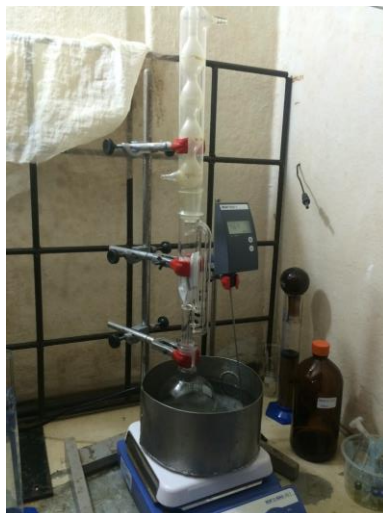
Figura IV.5 – Extração de lipídios do lodo de esgoto seco, pelo método Soxhlet.
