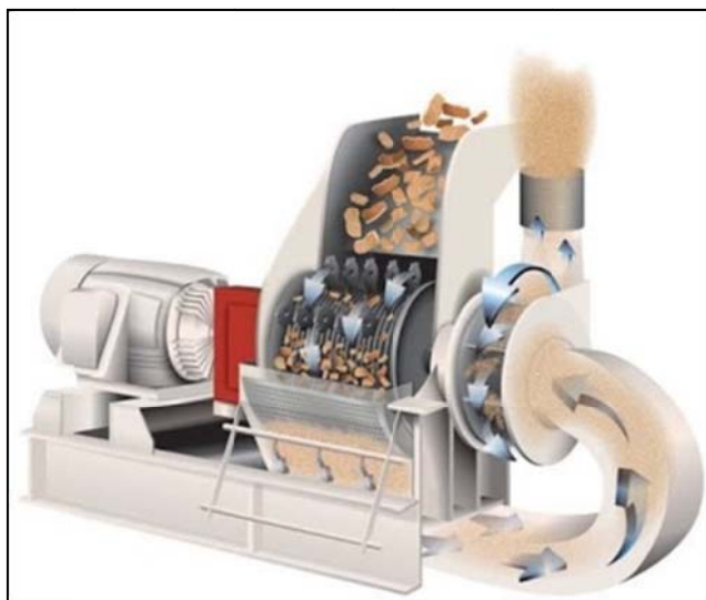
Figura 6 – Máquina de moagem-desfibramento para a fabricação de pellets de madeira.
