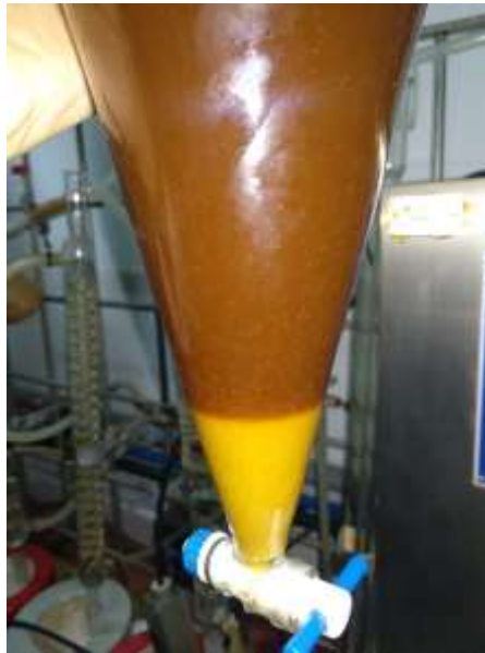
Figura 40 - Funil de separação contendo o mosto fermentado retirado do reator e as células decantadas.
