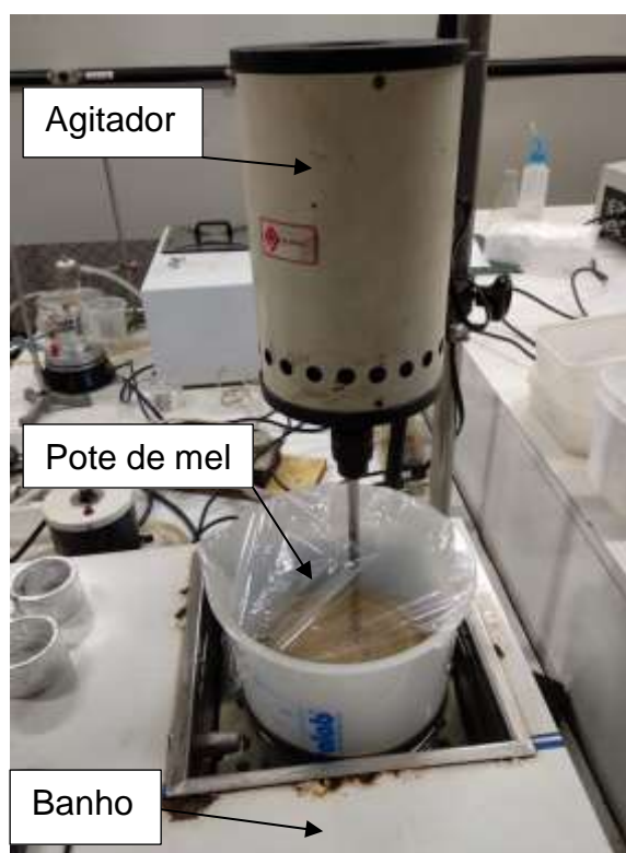
Figura 4 - Mel sendo invertido em banho termostático a 50°C com agitação mecânica.
