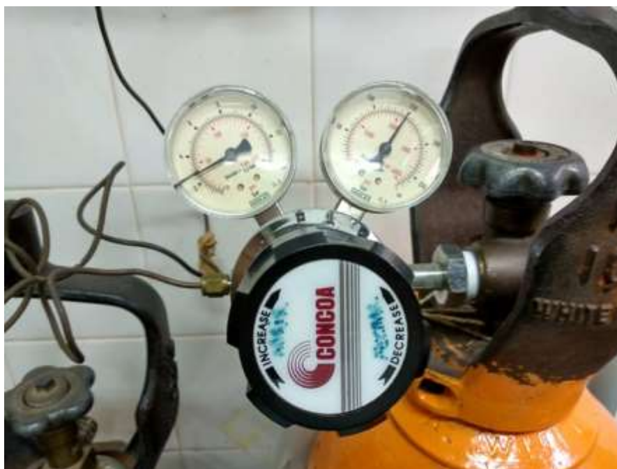
Figura 47 - Manômetros da saída de gás dos cilindros para o cromatógrafo.
