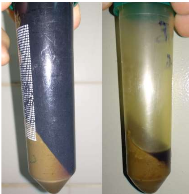
Figura 5 - Tubo de centrífuga contendo mel invertido a 300 g/L com precipitado formado por ação de polímeros como precipitado.
