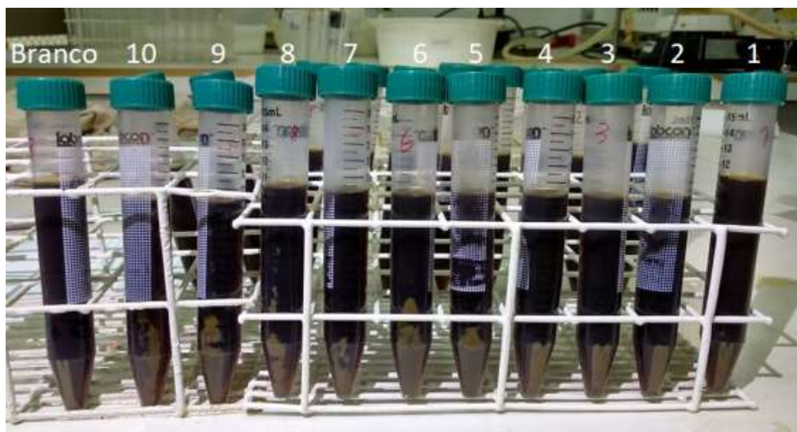
Figura 10 - Amostras com polímero catiônico AGP-1009 após centrifugação em pH 4,95, tubos 1 ao 10 + branco.
