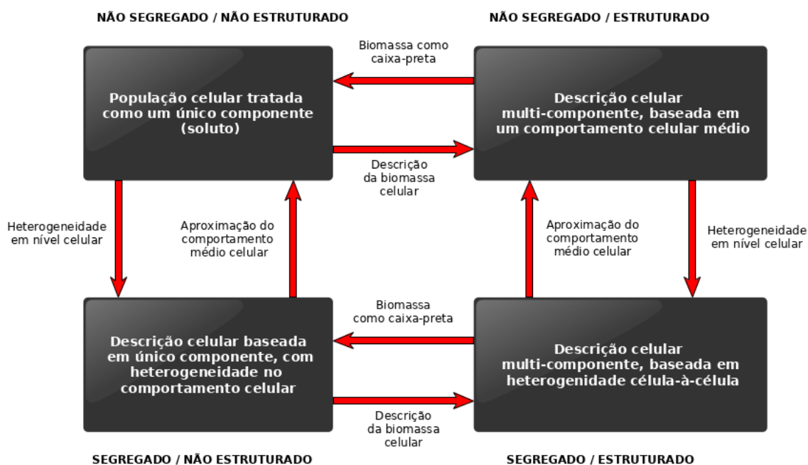
Figura 2 – Representação esquemática dos tipos de modelos mecanísticos utilizados na descrição dos processos biotecnológicos, destacando a diferença entre cada um deles
