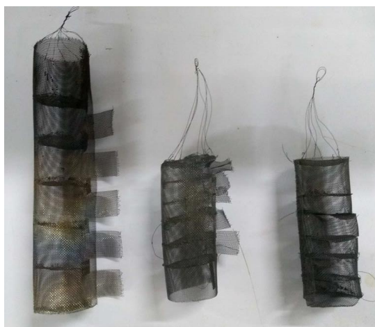
Figura 12. De esquerda a direita: Porta amostras utilizado para o processo de pirólise, ativação química com atmosfera inerte e ativação física com atmosfera oxidante.
