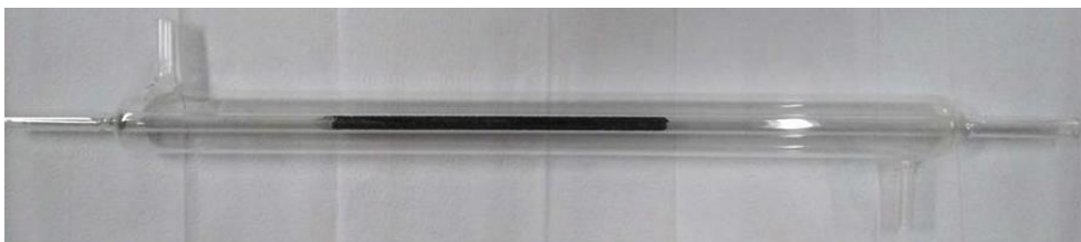
Figura 13. Foto da coluna de carbono ativado introduzida no condensador de Liebig.
