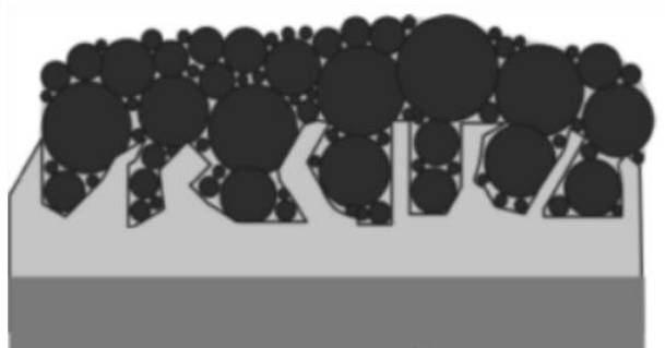
Figura 6: Efeito de ancoragem das partículas de catalisador por entre as irregularidades da superfície de um monólito. FONTE: Almeida et al. (2010)
