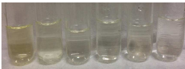
Figura 37. Amostras coletadas durante o teste fotocatalítico do corante Amarelo Reativo BF-3R empregando o catalisador ZnO.
