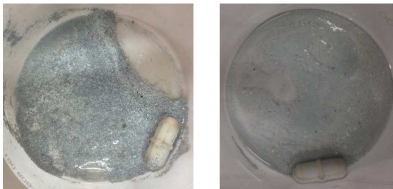
Figura 63. O catalisador \text{Nb}_2\text{O}_5\text{H} após o teste fotocatalítico com I) efluente sem filtração e com II) efluente filtrado.
