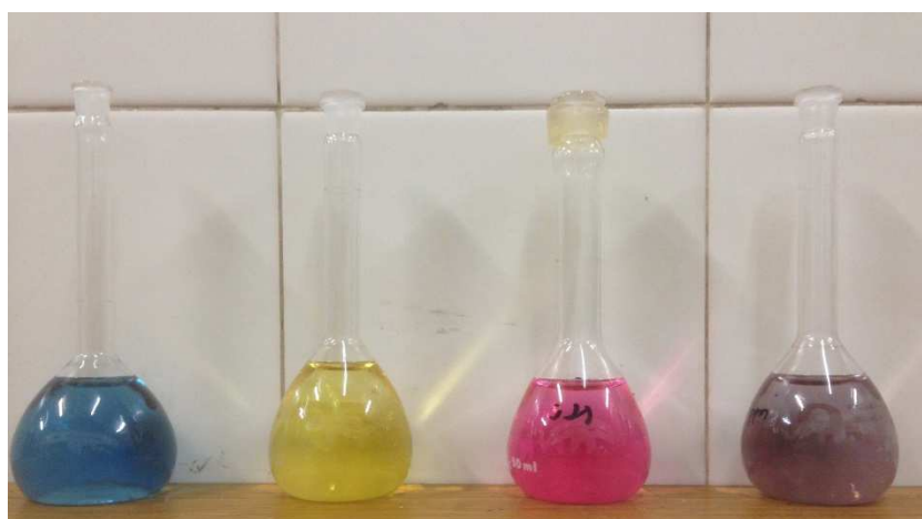
Figura 6. Soluções, dos corantes e da mistura dos mesmos, utilizadas na avaliação fotocatalíticas dos catalisadores.
