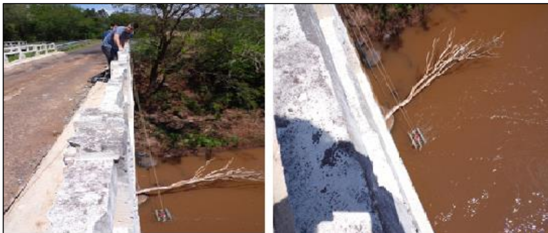
Figura 14 – medição de dados hidráulicos com equipamento ADCP no ponto 4
