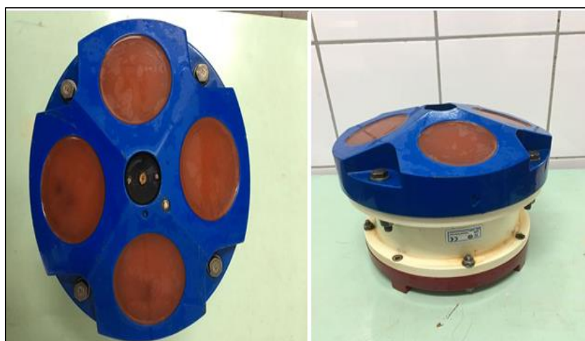
Figura 13 - Acoustic Doppler Current Profiler utilizado para medições hidráulicas
