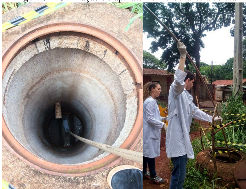
Figura 9 – Utilização do aparato no PV durante a coleta
