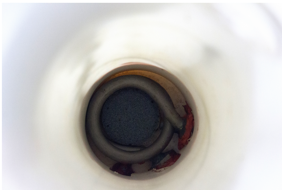
Figura 33 – Vista interna superior do reator mostrando a resistência e dispersor. Fonte: Autoria Própria.
