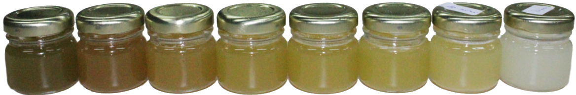
Figura 42 – Resultado visual da ozonização em caldo de cana-de-açúcar. Amostras ozonizadas com uma vazão de, aproximadamente, 20 \text{ mgO}_3/\text{min} . Os tempos de ozonização para cada amostra foram, da esquerda para a direita, 0 min., 1 min., 2 min., 3 min., 4 min., 5 min., 10 min. e 20 minutos.
