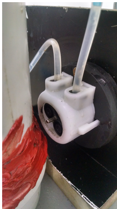
Figura 30 – Bomba Peristáltica. A figura mostra a bomba instalada na parte traseira inferior do reator. A mangueira mais à esquerda capta o caldo na parte inferior do reator e bombeia pela mangueira à direita através do sensor de absorbância localizado acima.
