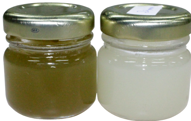
Figura 43 – Comparativo visual. À esquerda uma amostra do caldo de cana natural e à direita uma amostra de caldo de cana-de-açúcar (50 mL) ozonizada com uma vazão de \text{O}_3 de 20 \text{ mg}/\text{min} durante 20 minutos.
