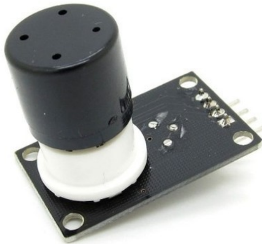
Figura 21 – Dispositivo Sensor de Ozônio com MQ-131. Fonte: Autoria Própria.
