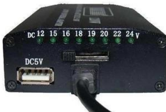
Figura 18 – Fonte Chaveada Universal - Entrada: 100-240 Vac - Saída: 12-24 Vdc. Fonte: Autoria Própria.
