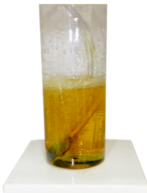
Figura 11 – Borbulhamento de Gás Ozônio ( O_3 ) em Solução de Iodeto de Potássio (KI). Fonte: Autoria Própria.
