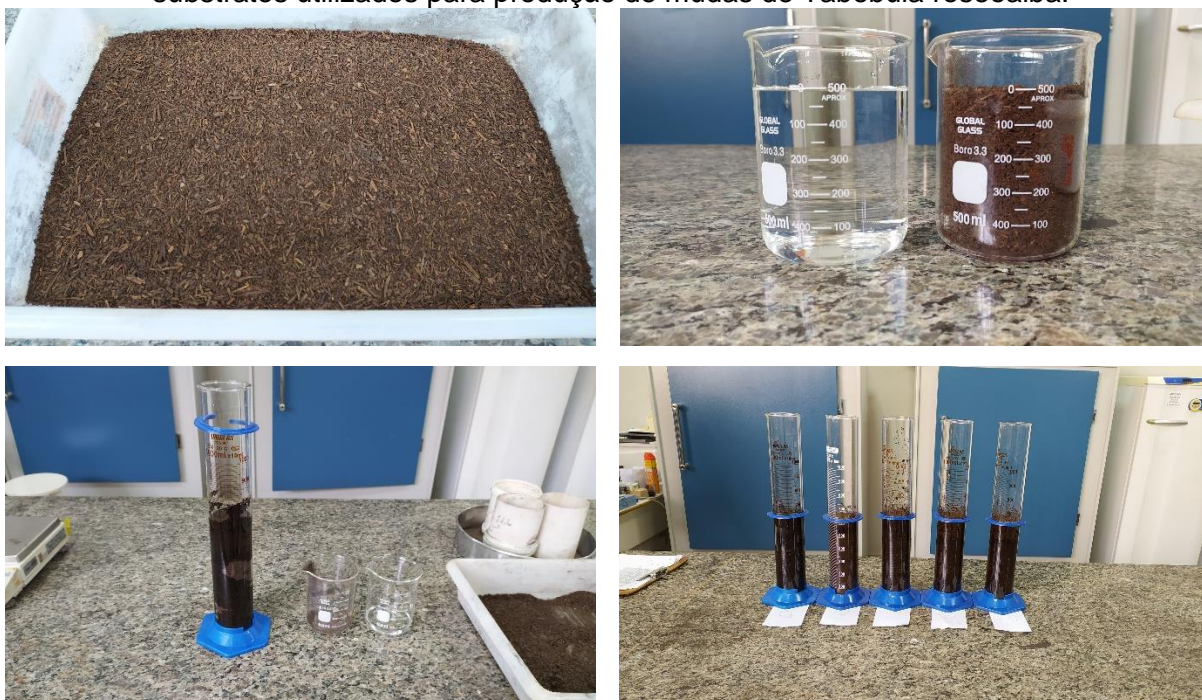
Figura 8 Procedimento para determinação de porcentagem de sólidos e de poros dos substratos utilizados para produção de mudas de Tabebuia roseoalba .
