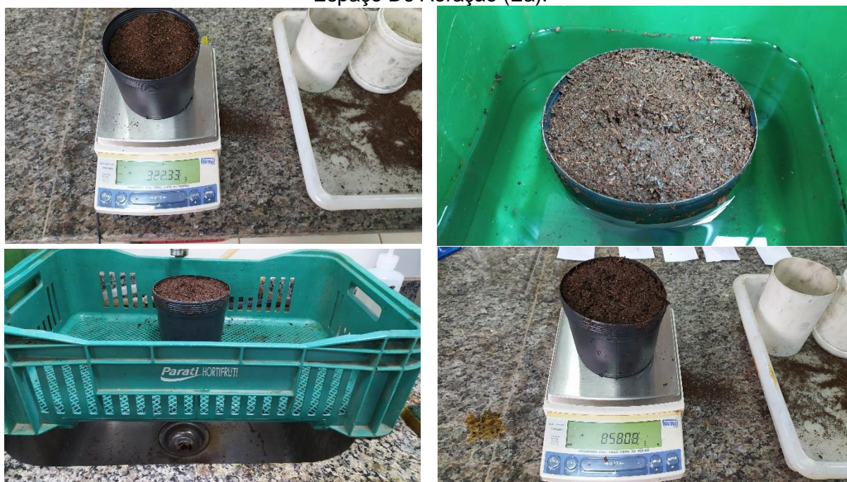
Figura 9 Procedimento Para Determinação De Capacidade De Retenção De Água (Cra) E Espaço De Aeração (Ea).
