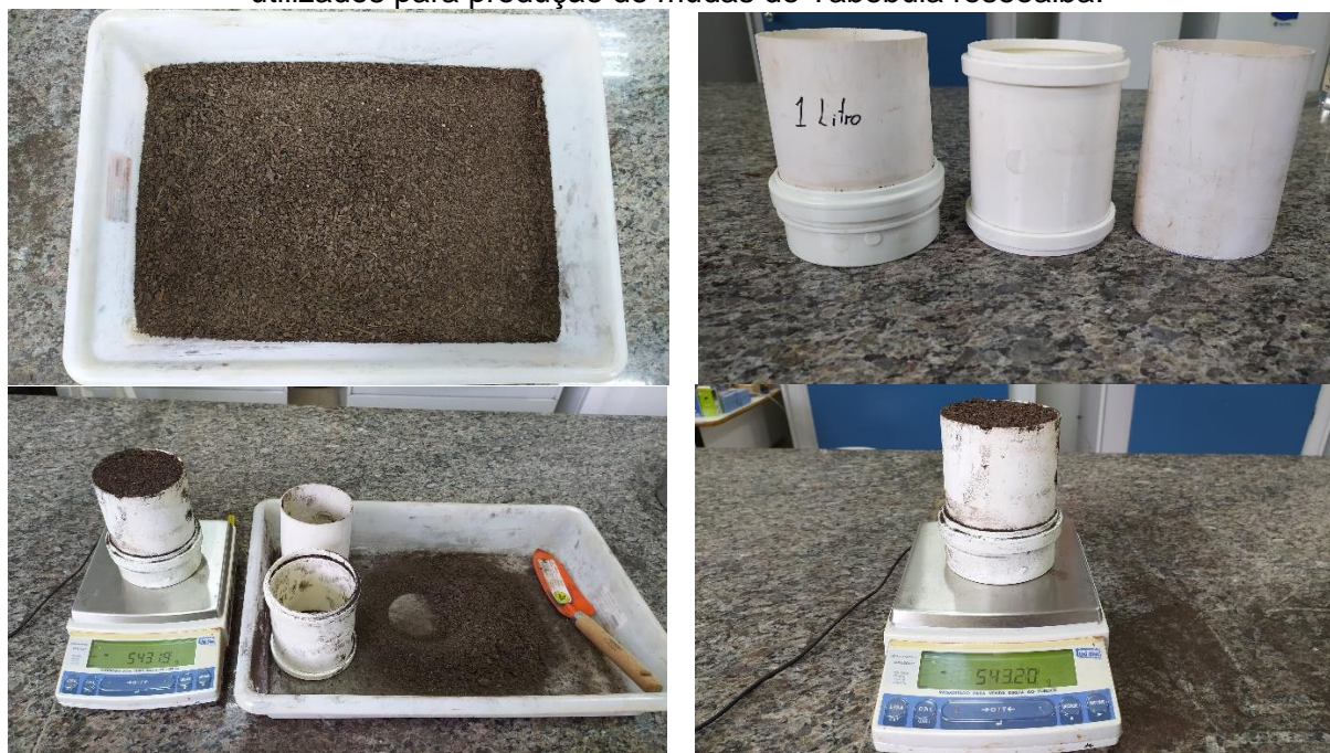
Figura 7 Procedimento para determinação da densidade seca (105°C) dos substratos utilizados para produção de mudas de Tabebuia rosealba .
