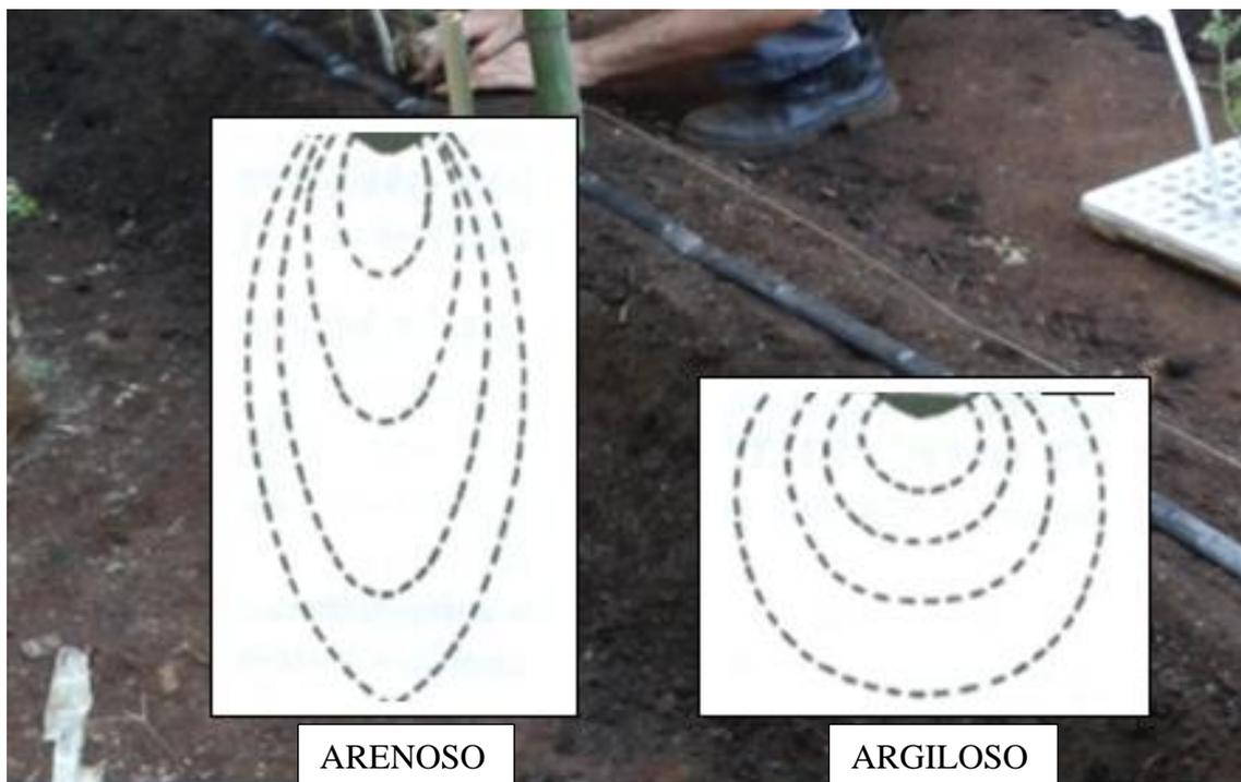
Figura 63. Gotejamento, distribuição da água conforme tipo de solo arenoso ou argiloso.
