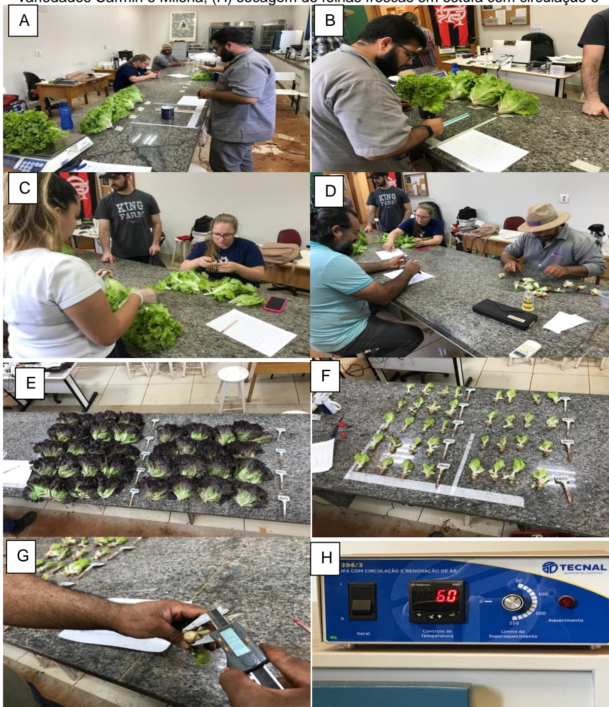
Figura 7 Avaliação do experimento. (A) pesagem da parte aérea; (B) aferição de diâmetro de cabeça; (C) contagem do número de folhas; (D, G) aferição de diâmetro do caule; (E, F) variedades Carmin e Milena; (H) secagem de folhas frescas em estufa com circulação e
