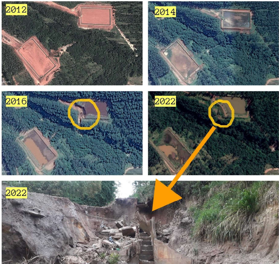
Figura 33 – Caixas de contenção de drenagens no ribeirão Paracatu entre 2012 e 2022
