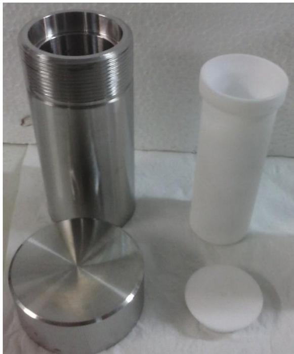
**Figura 4.** Mini autoclaves constituídas de reator de aço inoxidável e recipiente de Teflon<sup>®</sup>.
