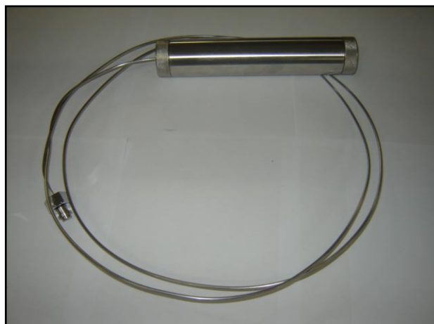
Figura 8. Reatores de aço inoxidável horizontal (a), vertical (b) e tubos de conexão (c) utilizados durante o processo de produção de carvões ativados.
