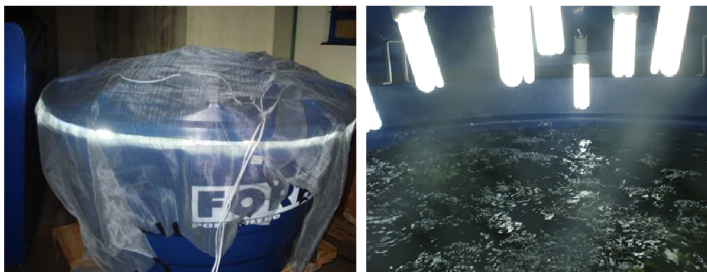
Figura 27 – Cultivo das microalgas em temperatura ambiente em biorreator de maior capacidade (500 L).
