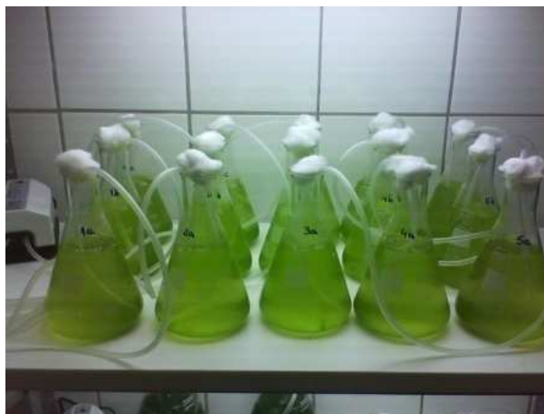
Figura 22 – Montagem dos experimentos para estudar a variação na concentração do meio MC no cultivo da microalga Scenedesmus sp.
