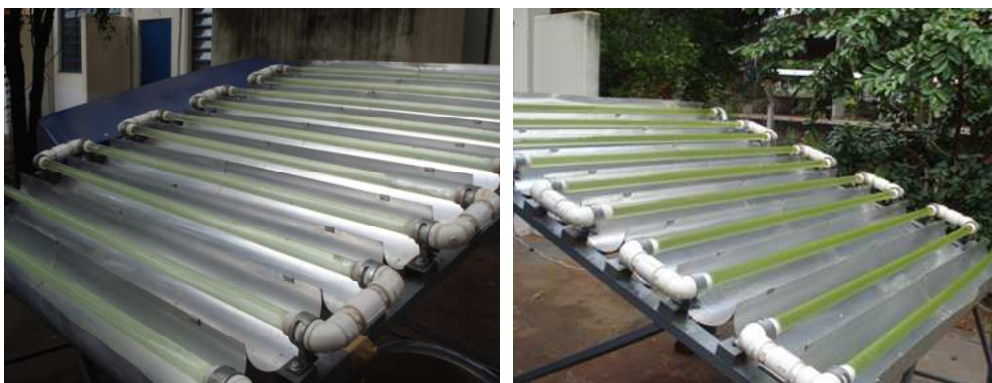
Figura 28 – Cultivo das microalgas em fotobiorreator de 30 L.
