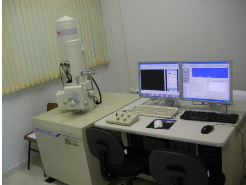
Figura 20 Microscópio de varredura Leo modelo 1450 VP
