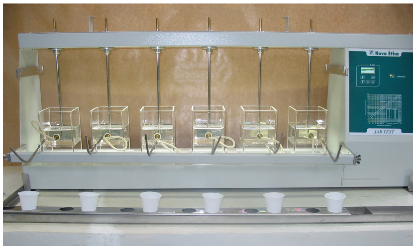
Figura 18 Aparelho “Jar test” utilizado nos ensaios em escala de bancada
