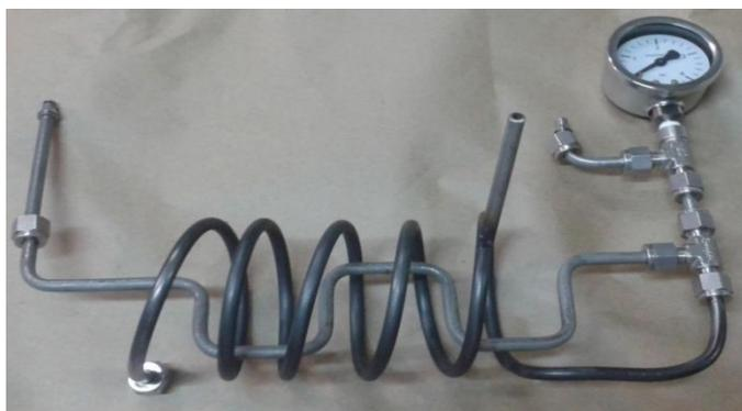
**Figura 3-4.** Imagem do evaporador do sistema reacional, na ausência das resistências e do isolamento.
