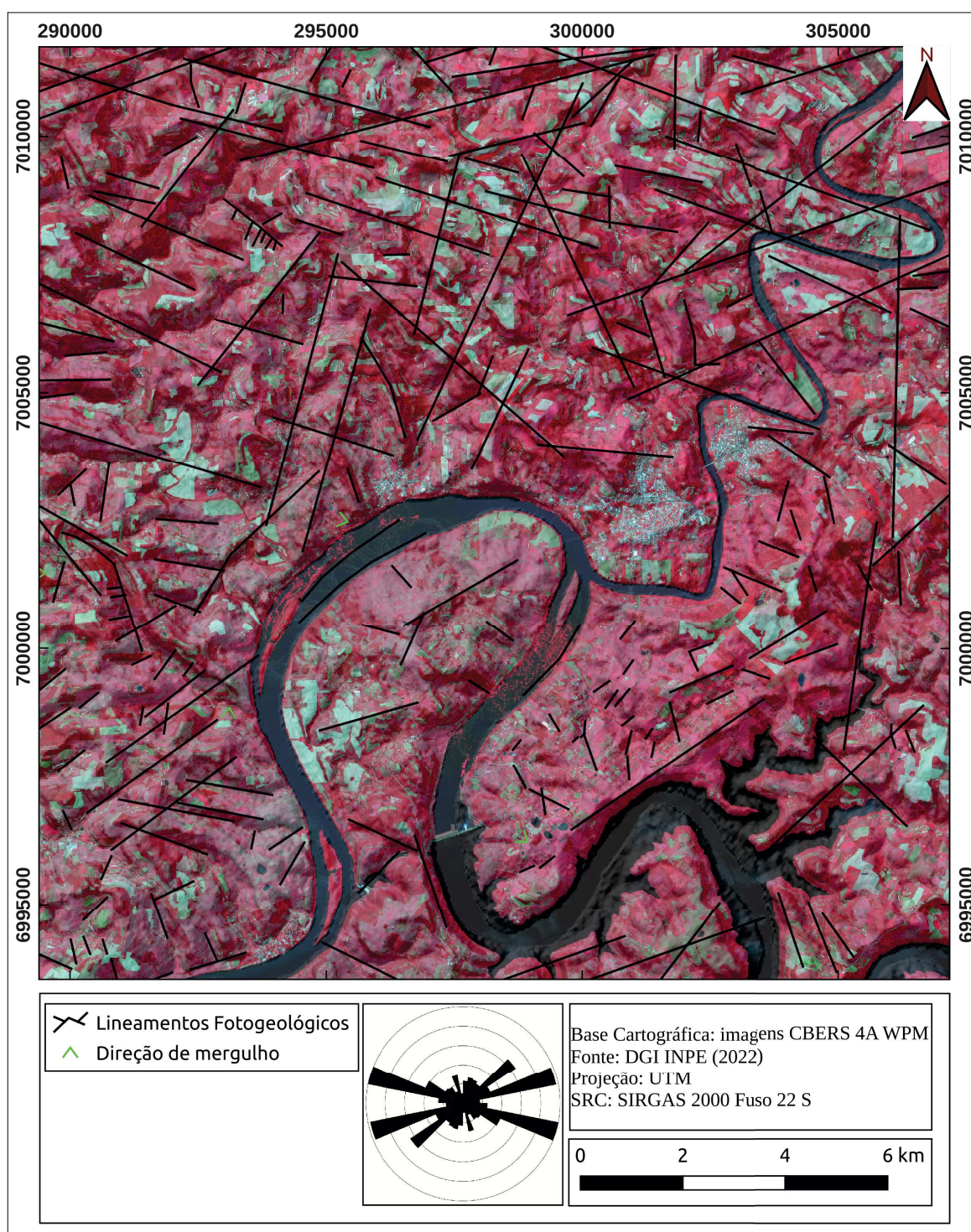
Figura 3.17- Lineamentos fotogeológicos delimitados na área da Volta Grande e direções de mergulho dos derrames vulcânicos.
