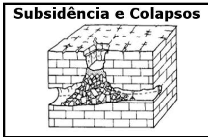
Figura 5: Escorregamento do tipo subsidência e colapsos de solo
