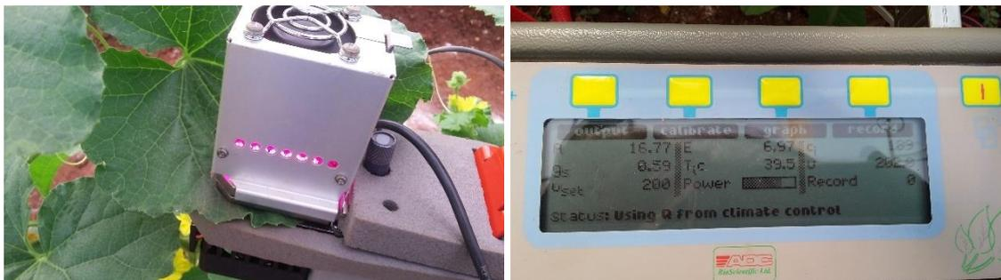
Figura 4. Detalhes do IRGA: câmara para medida das trocas gasosas com a fonte acoplada de irradiação e painel para leitura e armazenamento dos dados.
