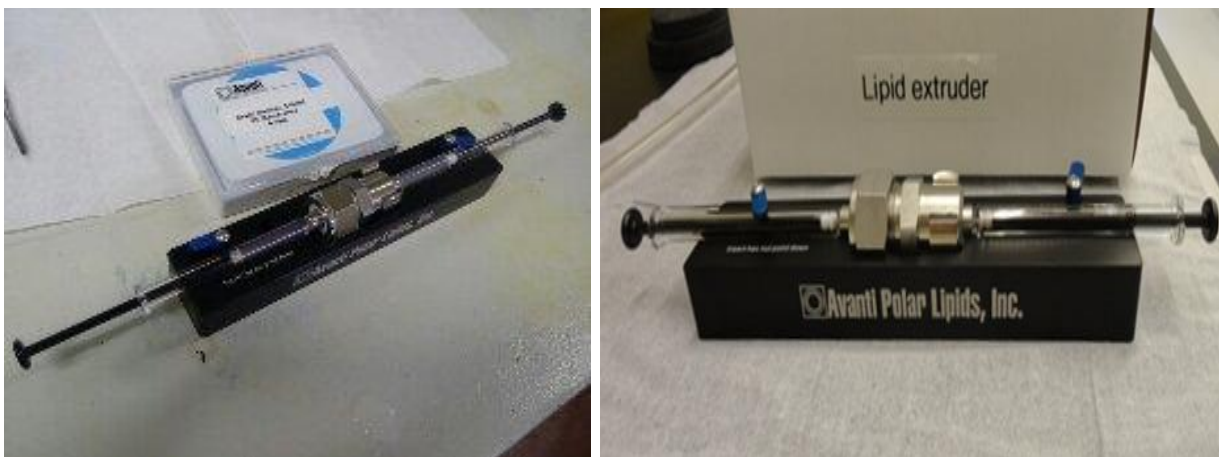
Figura 9. Extrusor Avanti Polar Lipidics, Inc. utilizado no processo de extrusão para uniformização das vesículas lipossomais de DPPC sobre a plataforma aquecida.
