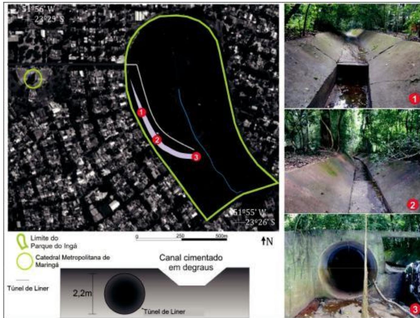
**Figura 40 – Mapa de escoamento de águas pluviais do Parque do Ingá**
