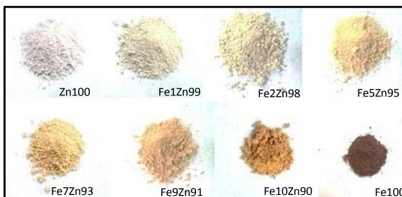
**Figura 19.** Imagem das amostras sintetizadas dispostas de acordo com a concentração (%mol) de Fe<sup>3+</sup>.
