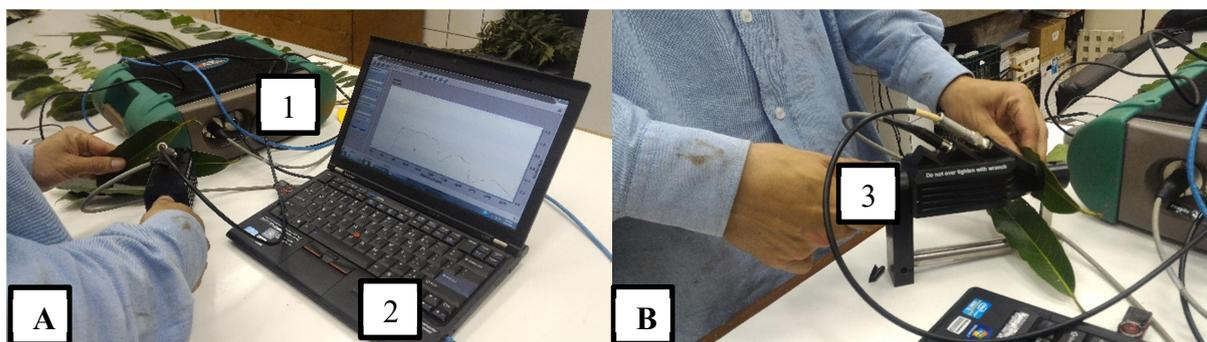
Figura 8. Demonstração de leitura radiométrica. A: (1) Espectrorradiômetro FieldSpec@3 Jr; (2) microcomputador portátil; B: (3) acessório ASD *Plant Probe*.
