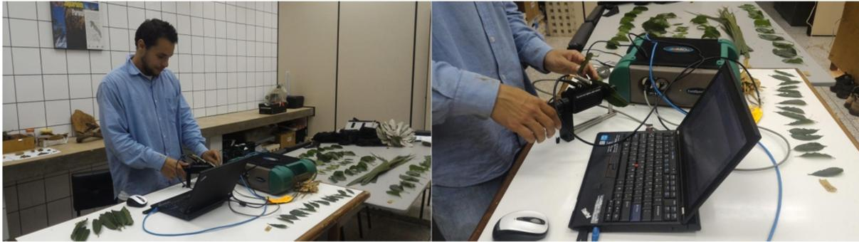
Figura 9: Leituras radiométricas das espécies nativas, realizadas no Laboratório da Flora (EEC), utilizando o espectrorradiômetro FieldSpec®3 Jr, ASD e acessório *Plant Probe*.
