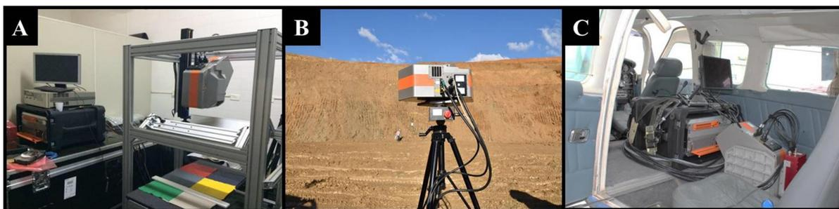
Figura 10. Sensor hiperespectral AisaFENIX (SPECIM) em três diferentes níveis de aquisição de dados, (A) em laboratório, acoplado à plataforma Lab-Scan; (B) no campo, acoplado ao tripé; (C) a bordo de aeronave.
