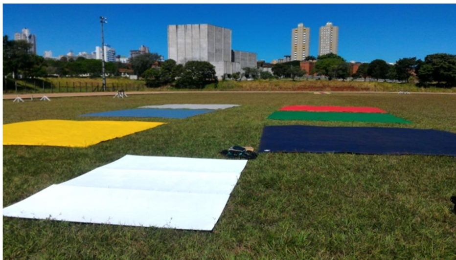
Figura 14. Alvos padrões utilizados para a correção atmosférica das imagens geradas pelo sensor hiperespectral AisaFENIX, SPECIM.
