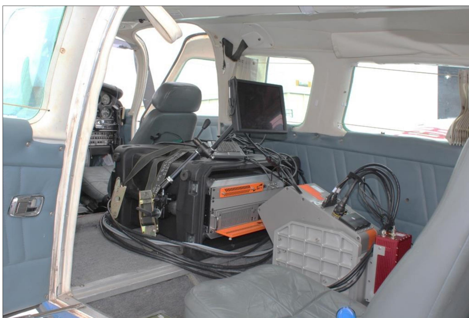
Figura 10. Sensor hiperespectral AisaFENIX, SPECIM, acoplado em aeronave, para realização do aerolevanteamento nas áreas de estudo, no dia 01/05/2016.
