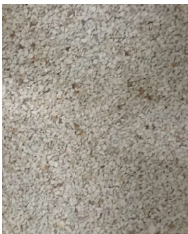
Figura3.1: Imagem da zeólita natural clinoptilolita utilizada para o preparo dos catalisadores.
