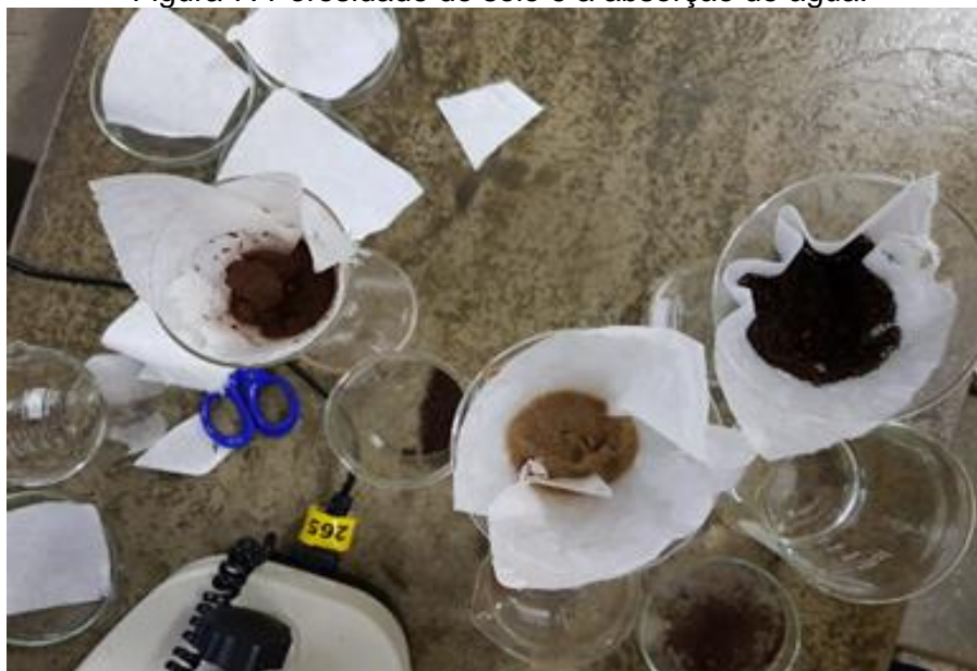
Figura 7: Porosidade do solo e a absorção de água.
