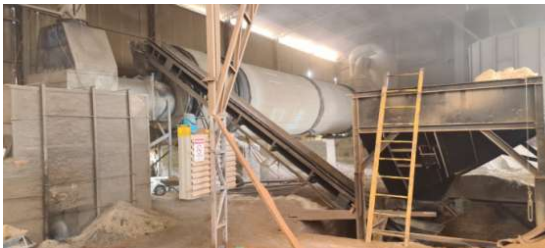
Figura 25 - Forno de secagem da areia
