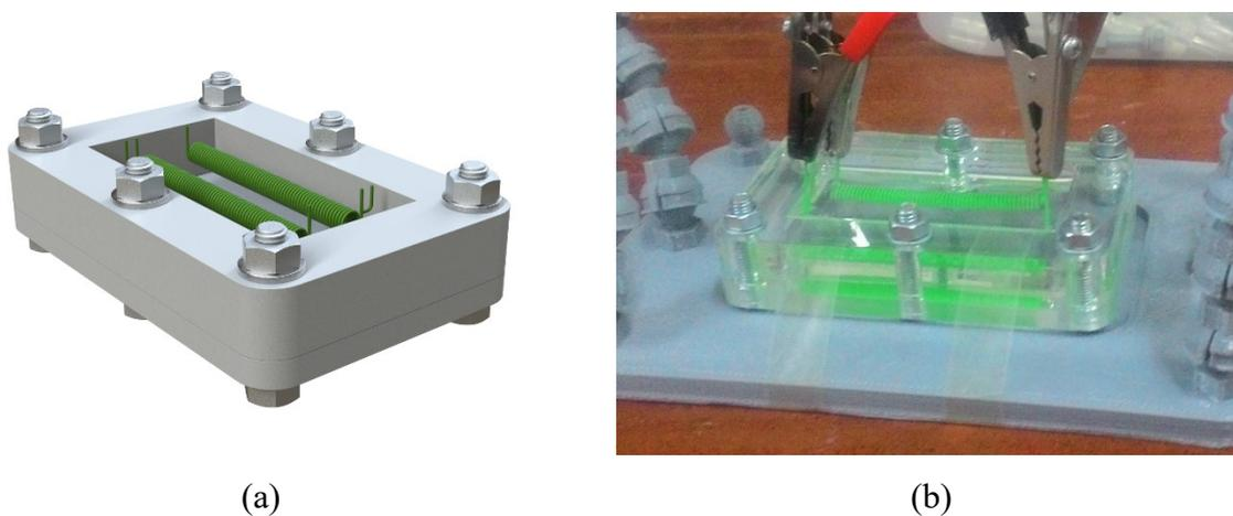
Figura 22 – Molde de acrílico para a moldagem do reator de PDMS: (a) modelo CAD; (b) peça real.
