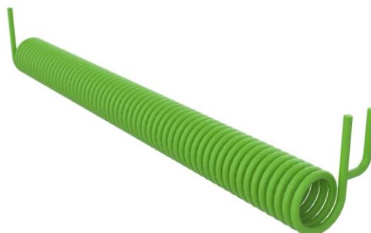
Figura 21 – Modelo tridimensional de uma espiral de ABS com 1 m de comprimento.
