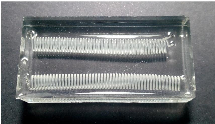
Figura 23 – Reator de PDMS pronto para uso.
