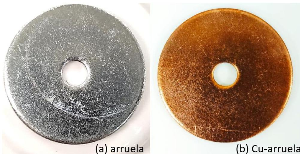
**Figura 5.2.** Fotos das arruelas de aço carbono galvanizado antes e após o processo de deposição de cobre por *Electroless Plating*: (a) arruela e (b) Cu-arruela.
