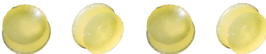
Figura 2: Corpos de prova confeccionados utilizando matriz plástica transparente.
