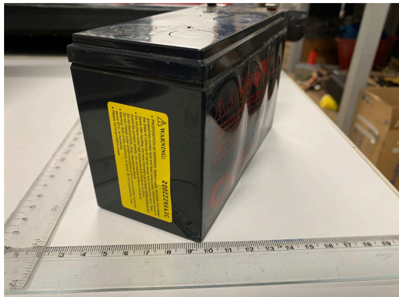
Figura 5.12: Estufamento das baterias.
