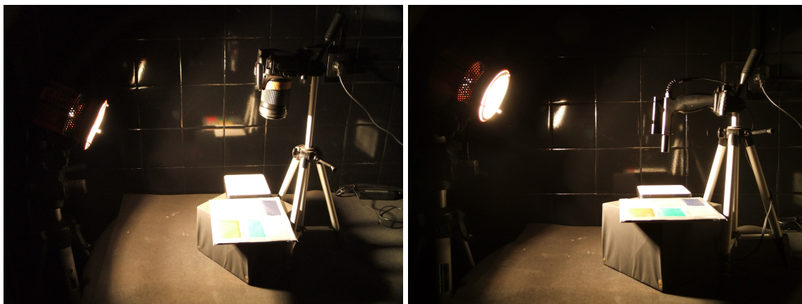
Figura 12. Posicionamento da câmera fotográfica multiespectral (esquerda) e espectrorradiômetro (direita) em ambiente controlado.
