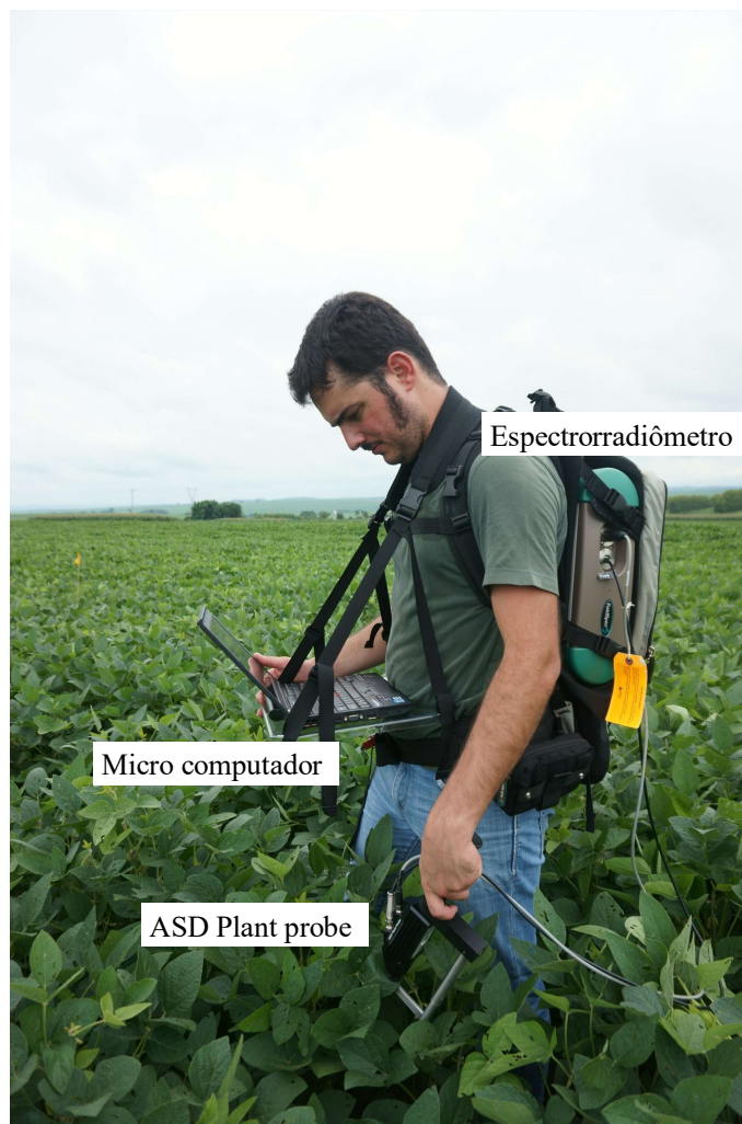
Figura 7. Sistema operacional em campo do Fieldspec 3 Jr.
