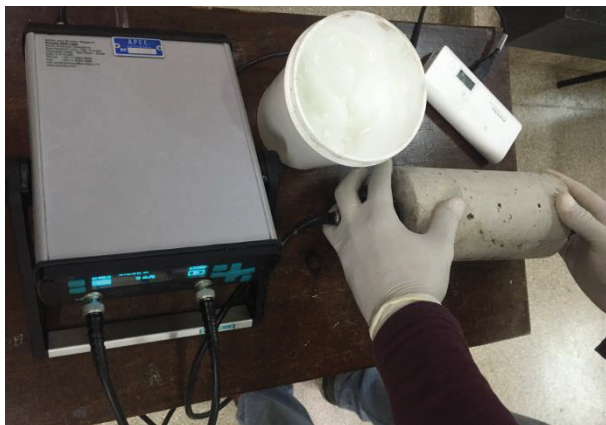
Figura 3.14 – Ensaio ultrassônico com transmissão direta
