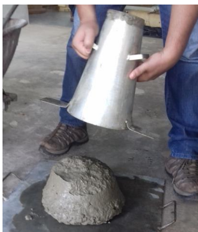
Figura 37 – Ensaio de abatimento de tronco de cone
