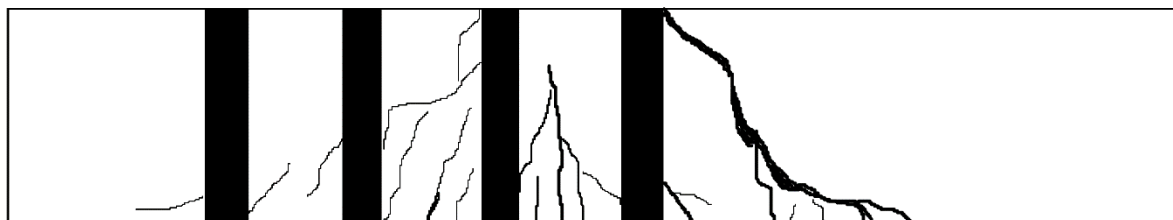
Figura 89 – Panorama de Fissuração – Viga VC2
