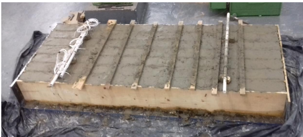
Figura 38 – Vigas após moldagem
