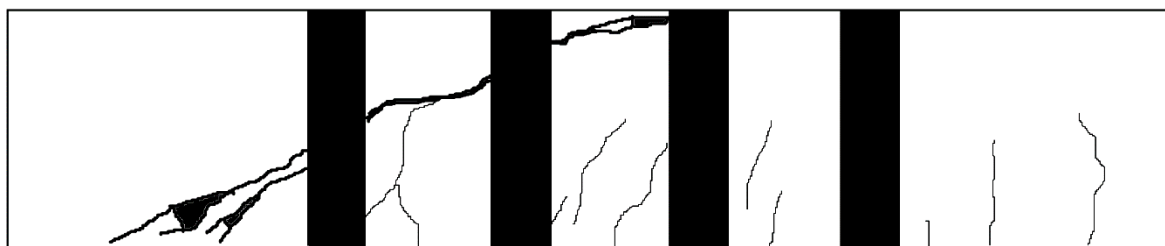
Figura 84 – Panorama de fissuração– Viga VC0-90
