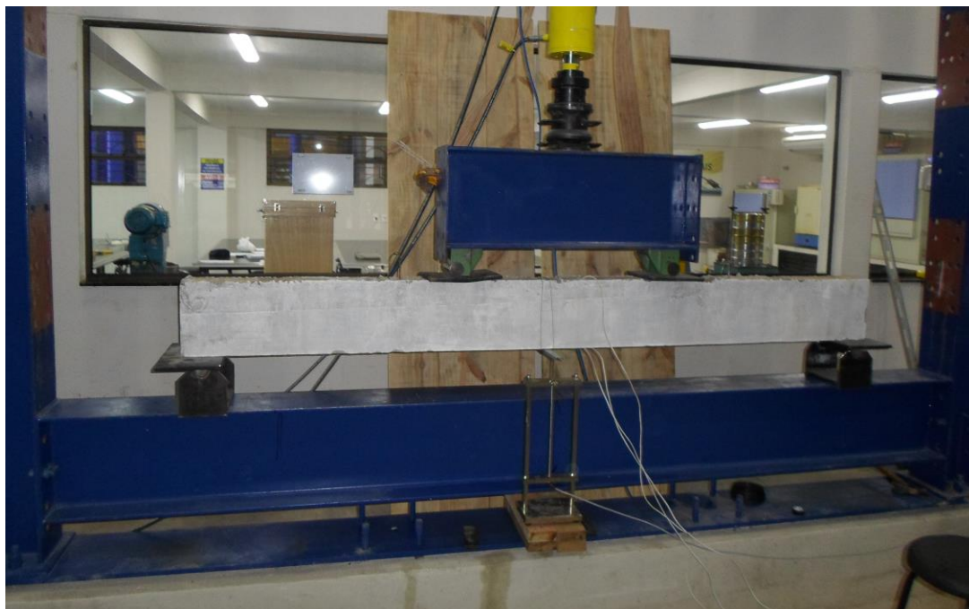
Figura 48 – Vigas com aplicação de carregamento
