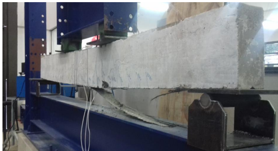
Figura 74 – Ruptura do reforço – Viga VF3
